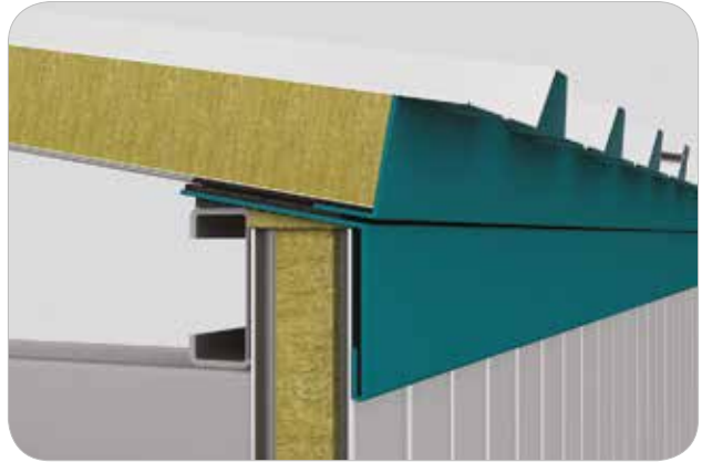
Ön Alın Kaplama Detay / Front Covering Detail
