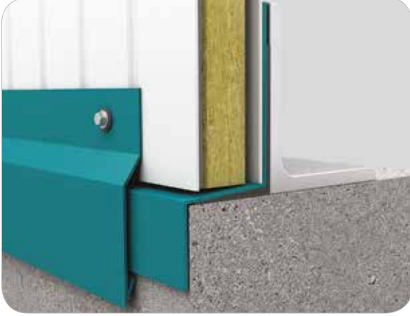
Damlalık Detayı / Drip Box Detail
